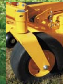
Maskinen är försedd med kraftiga pivothjul.
