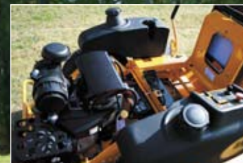
Motorn sitter lågt och kyler även hydrostatoljan.
